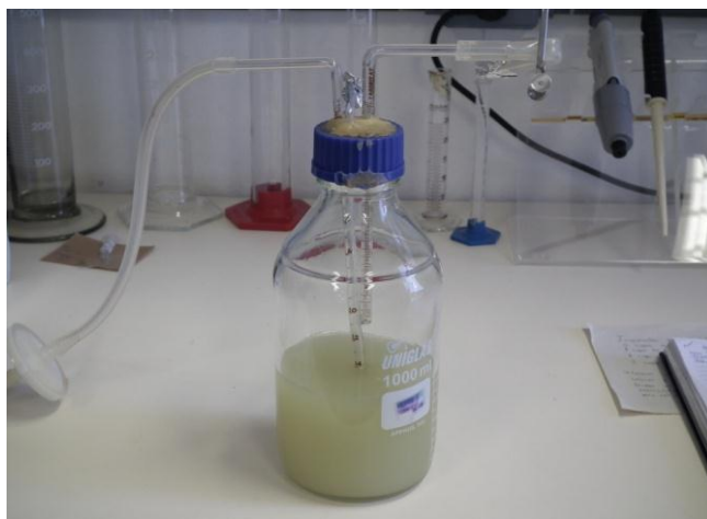
Figura 6. Inóculo de Pseudomonas oleovorans a partir de extrato de mandiocaba suplementado com fosfatos e sulfato de amônio como fonte de nitrogênio.
