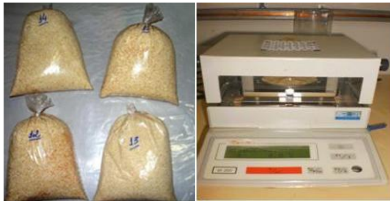
Figura 1. Mistura das farinhas de milho e maracujá e peixe, acondicionadas e embaladas e medida da umidade.
