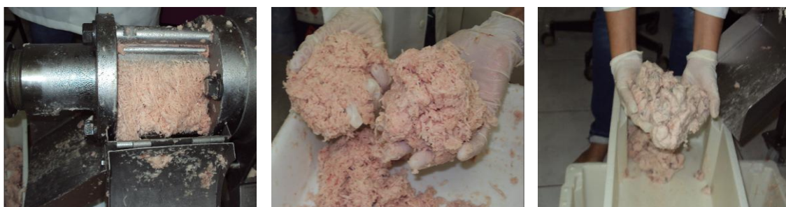
Figura 1. Processamento do resíduo da filetagem de piramutaba para a formação de Carne Mecanicamente Separada (CMS).
