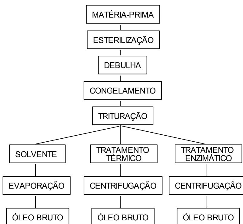
Figura 12: Fluxograma dos experimentos dos processos de extração de óleo de palma
