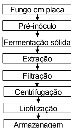
Figura 13: Fluxograma da produção de extrato de Tanase por Paecilomyces variotii .
