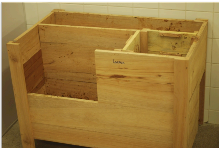
Figura 11. Caixa de fermentação baseada na caixa t-60 com dimensões reduzidas (largura e comprimento).
