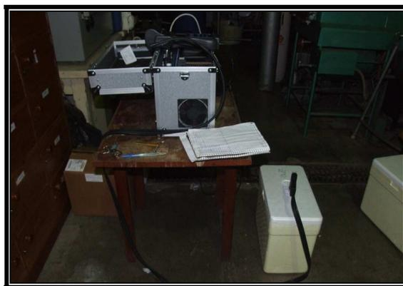
**Figura 19.** Aparato para medir a concentração de  $O_2$  e  $CO_2$  no interior das caixas de isopor.
