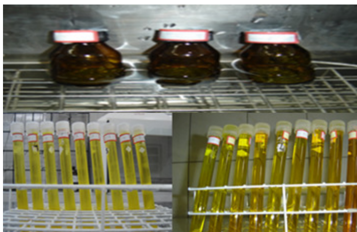
Figura 14. Hidrólise em frascos âmbar (superior); determinação de DNS (inferior esquerda e direita)
