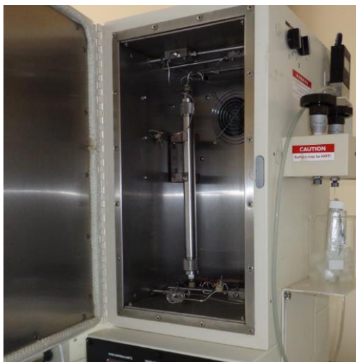
Figura 8. Interior do forno da unidade de extração com o vaso extrator conectado aos dutos capilares (Fonte: Autor).
