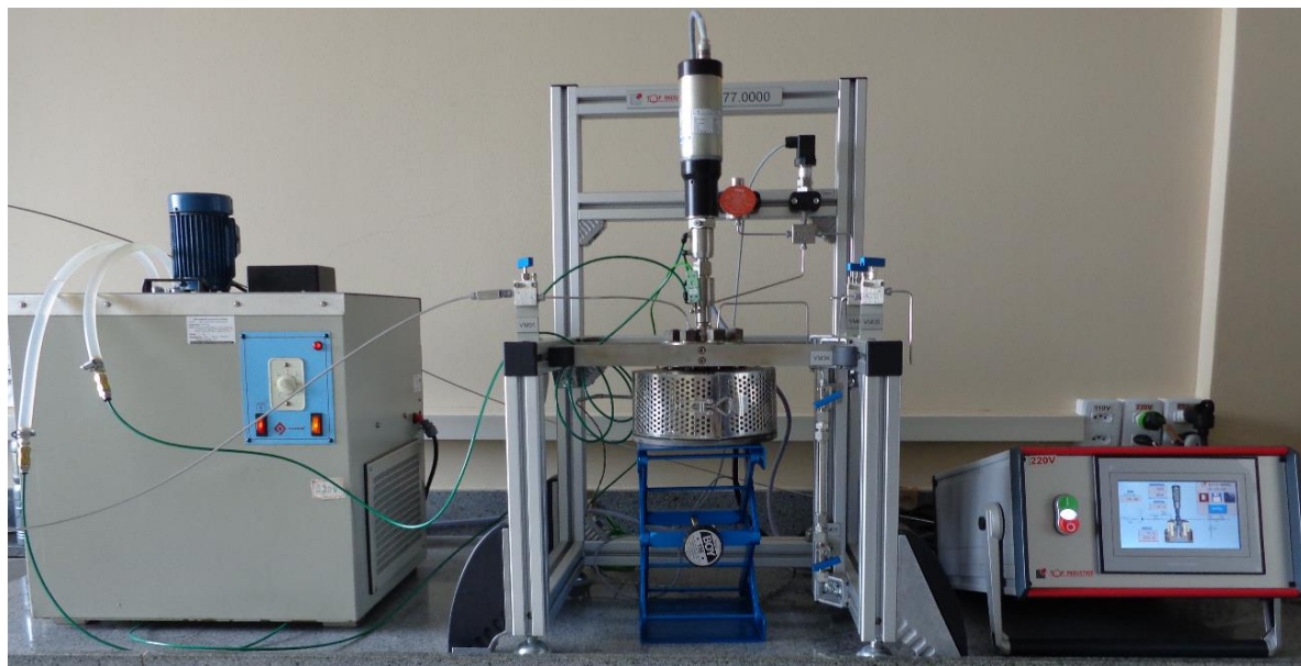
Figura 10. Aparato experimental da reação de transesterificação do extrato oleoso das FPP com etanol e CO 2 em condições supercríticas ( Fonte: Autor)
