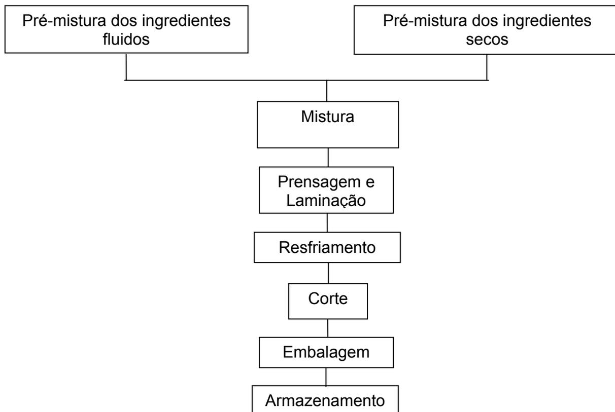
**Figura 7: Processamento da barra de castanha-do-Brasil.**
